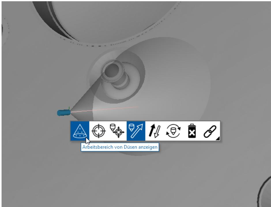
Bei Zerstäuberdüsen wird der Arbeitsbereich einer Düse als Kegel angezeigt. Bei Sprühkugeln und Zielstrahlreinigern als Kugel.
